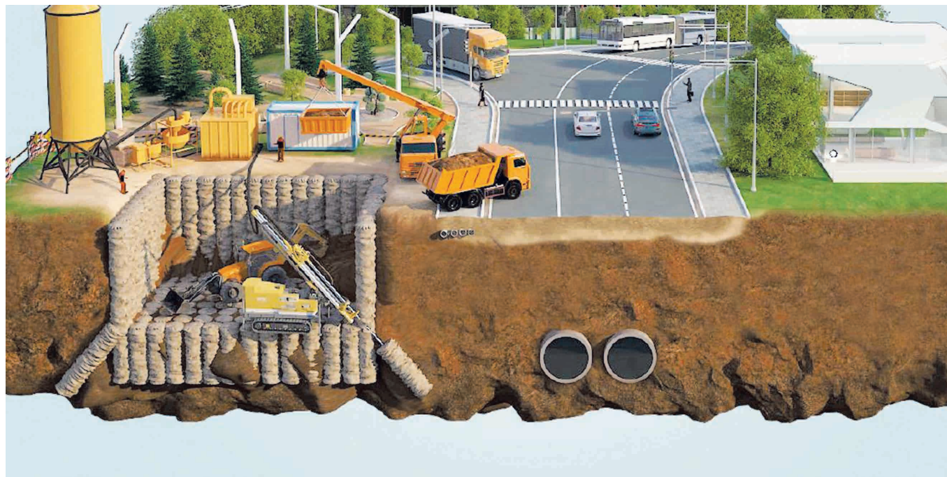
«Jet grouting» tehnologiýasy boýunça sementleşdirmek usuly «Jet grouting» cementation method Метод цементации по технологии «jet grouting»
