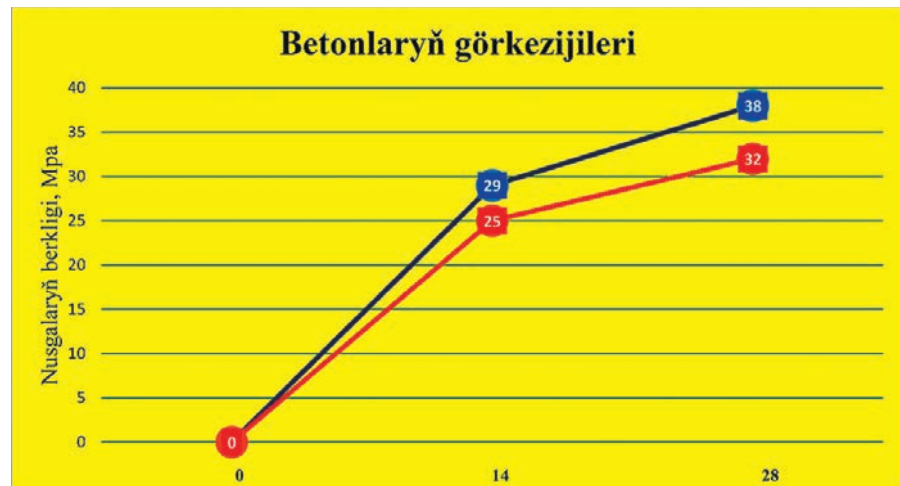
1-nji diagramma. Sement/çagyl Sement/dolduryjy 1:8 gatnaşykda taýýarlanylýan betonyň 14 we 28 günlerde berklik çägi.
